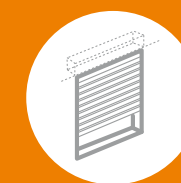
Geïntegreerd rolluik in de spouwmuur
