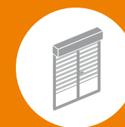
Opbouw rolluik geïntegreerd in het raam
